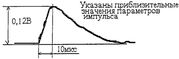
Рис.4. Вид импульса на резисторе R1.
