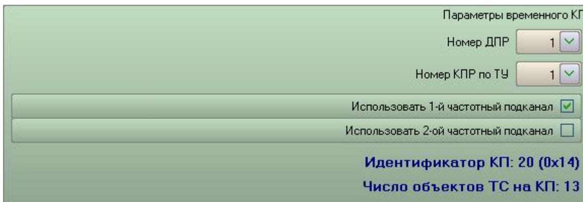
В качестве дополнительной информации выводится максимально возможное число объектов ТС на КП в зависимости от его номера КПР по ТУ (от 10 до 13).
